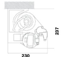
Instalación en el techo (en mm.)
