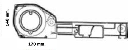
**Obligada motorización.** Funcionamiento con motor y sistema de circuito de poleas y cables que permiten que el tejido se mantenga tensado en todo su recorrido.
