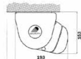
Instalación en el techo (en mm.)
