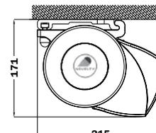
Instalación en el techo (en mm.)
