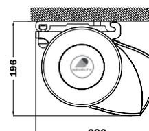
Instalación en el techo (en mm.)
