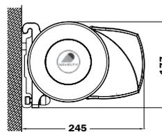
Instalación en la pared (en mm.)
