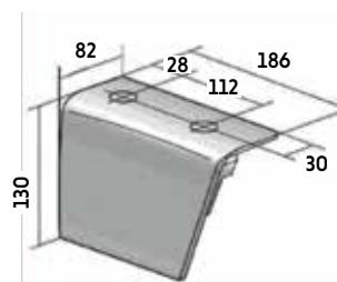
Instalación en el techo (en mm.)
