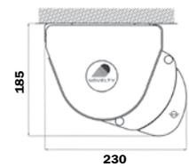
Instalación en el techo (en mm.)
