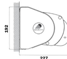
Instalación en la pared (en mm.)
